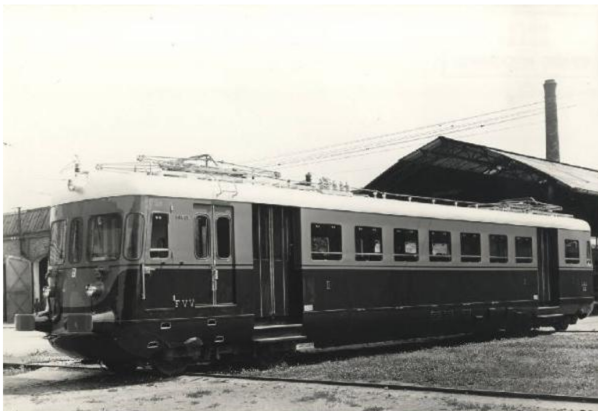
1957 - Elettromotrice - Equipaggiamento elettrico per c.c. a 3000 V. con 4 motori da 205 CV. per Ferrovia Voghera-Varese
