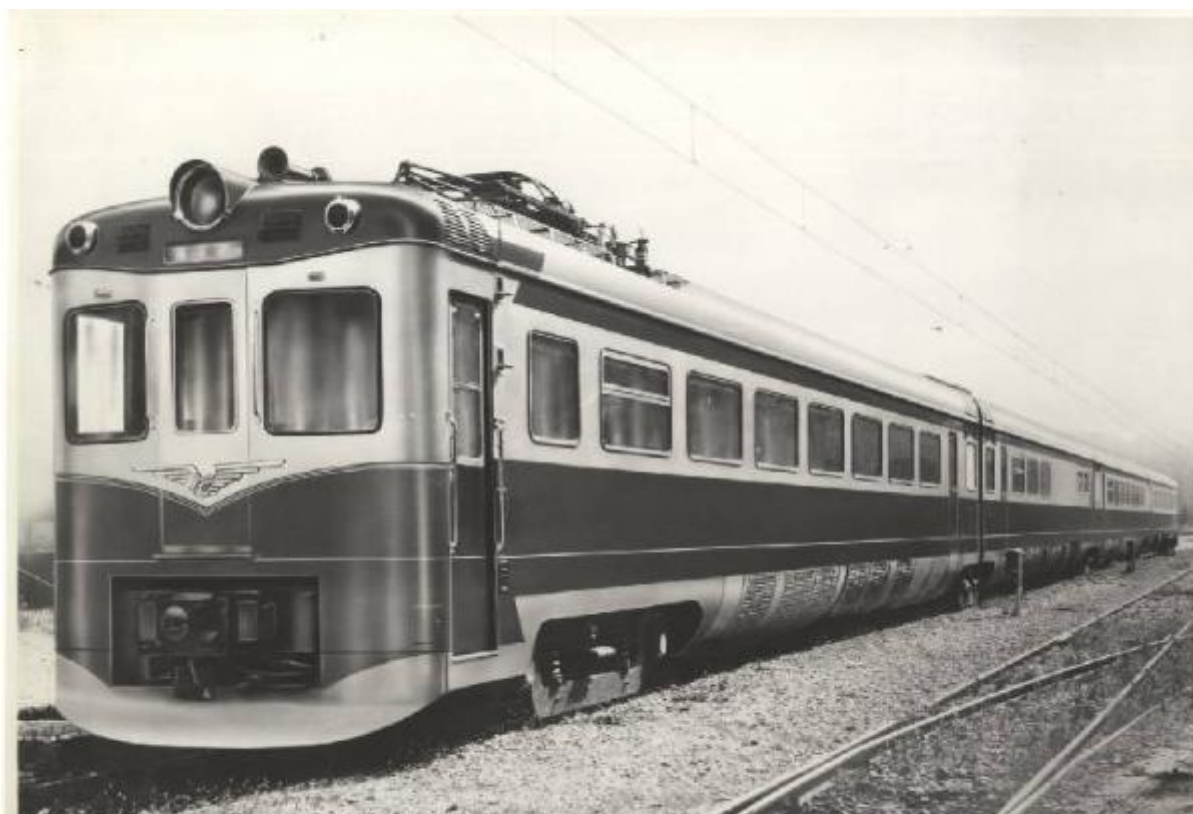
1960 - Elettrotreno di lusso a 4 carrozze - Equipaggiamento elettrico per c.e. a 3000 V con 4 motori da 373 kW per Ferrocarriles del Estado - Chile
