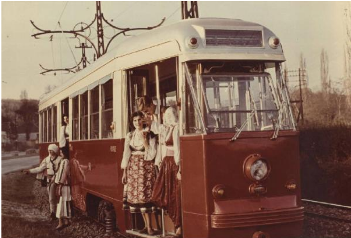
1960 - 1 Motrice tranviaria urbana a corrente continua 600 V. - n.4 motori. interamente sospesi - potenza oraria complessiva 300 CV. - per Azienda Tranviaria di Belgrado
