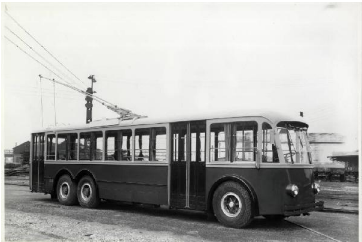
1936 - Carrozza filoviarria a due assi - Equipaggiamento elettrico per c.c. a 550 V con un motore da 120 CV. per ATAO - Roma
