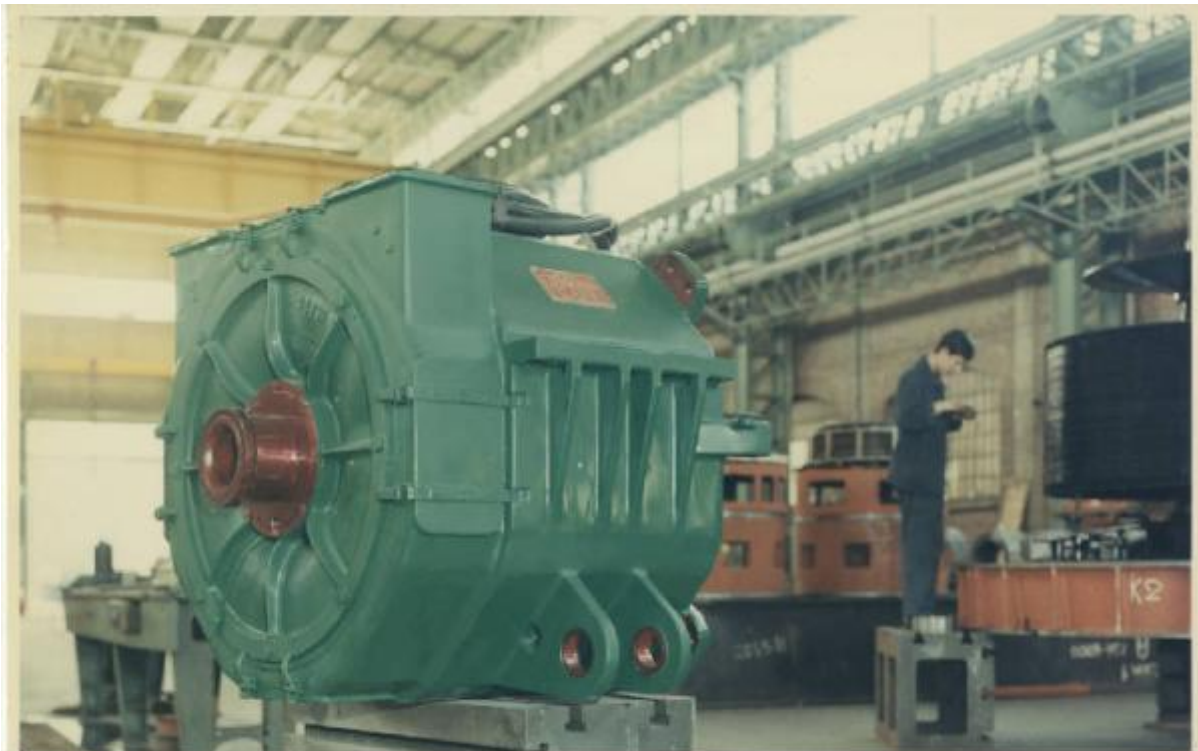
10156/956 - Motore di trazione Broda tipo ETBC 039/17 - c.c. - eccitazione serie - 550 KW - 985/576 A - 640/1080 V per locomotive Diesel Elettriche tipo D 443 e D 343 per Ferrovie Italiane dello Stato
