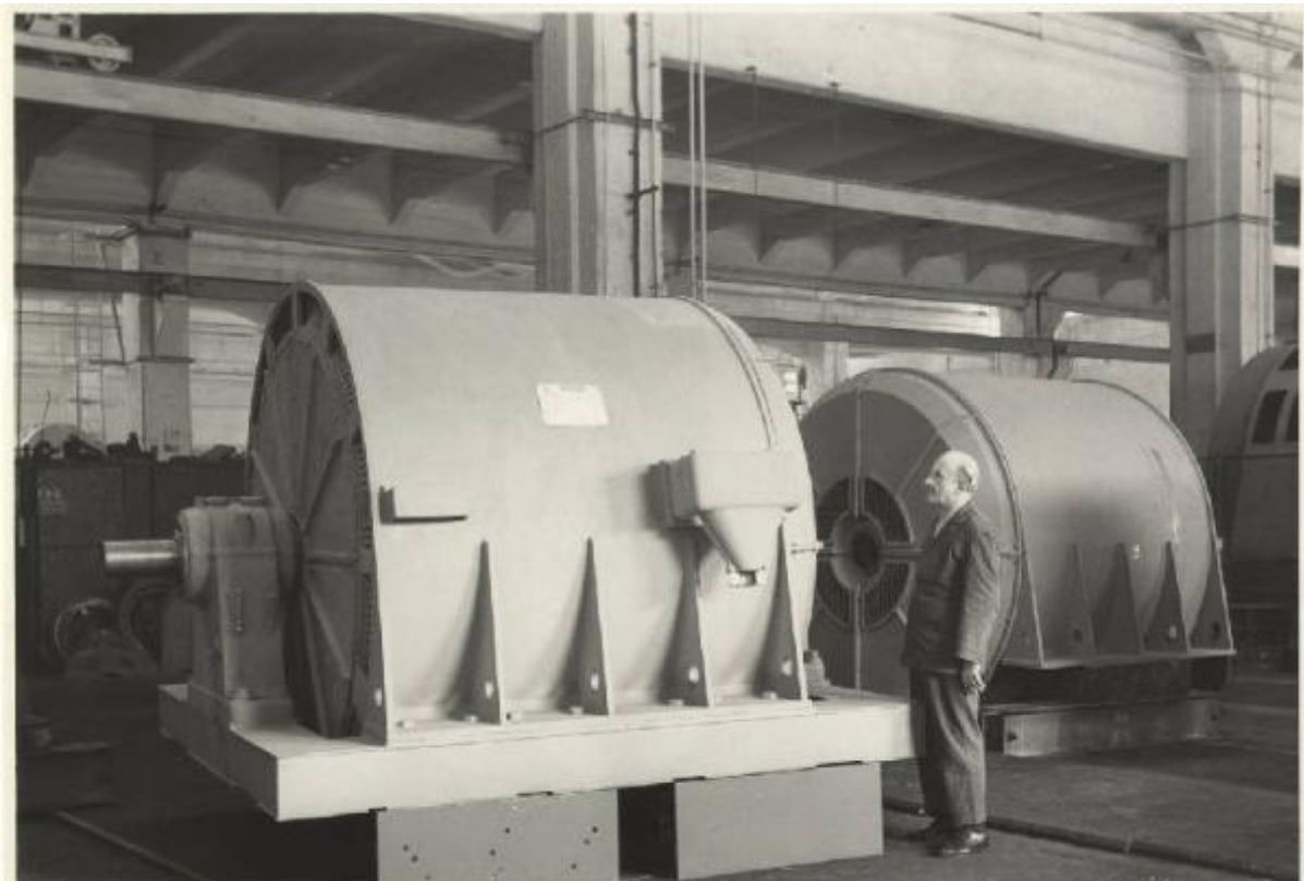
1962 - 4 Motori asinroni trifasi completamente chiusi per azionamento ventilatori tiraggio indotto 2150 HP - 3000 V - 50 Hz - 590 giri/1' per Società Mineraria Carbonifera Sarda - U.le Sulcis di Porto Venere
