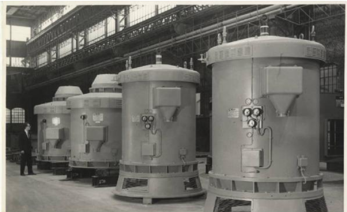
1965 - 2 Motori asincroni trifasi in corto circuito completamente chiusi con ventilazione esterna - 1070 HP - 6000 V. - 50 Hz - 425 giri/1' - 2 Motori asincroni trifasi in cortocircuito completamente chiusi con ventilazione esterna - 1400 HP - 6000 V. - 50 Hz - 990 giri/1' per E.N.E.L. - Compartimento di Torino C.le di Chivasso II
