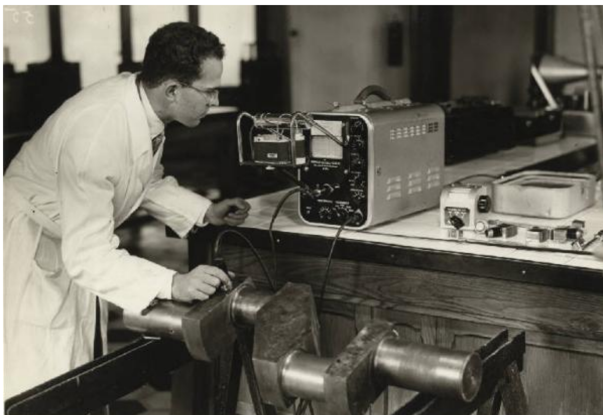
ESAME CON ULTRASUONI - ULTRASONIC INSPECTION
